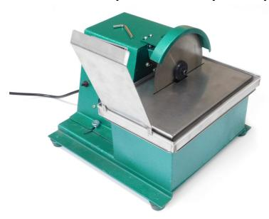
Inclus une lame de scie diamant fritté Ø 150mm, épaisseur 0.80mm Trou central 20.0mm, profondeur de coupe 57mm
